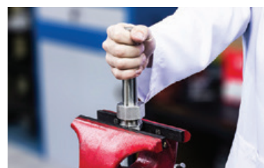
Encaixe a extremidade do tubo no fundo do assento cônico do dispositivo de cravação
