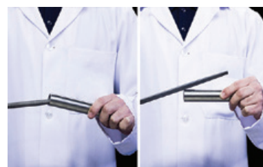
Rebarbe o Tubo interna e externamente
