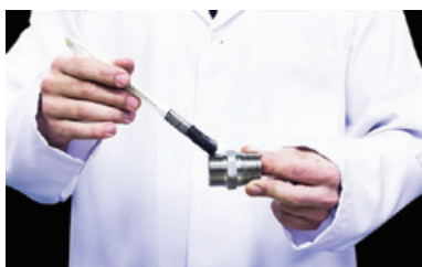
Lubrificar a rosca e o assento cônico do dispositivo de cravação (DC)
