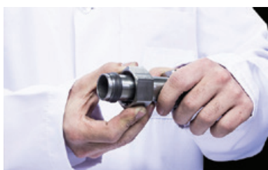
Coloque sobre o tubo a porca e depois o anel
